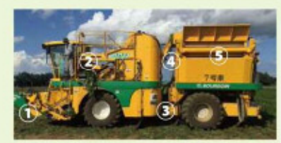
●ハーベスターの構造 ①前方のブラシと圧迫ローラーで収穫されたえだまめは、②茎や葉だけが排出されます。③さらに強いファンで軽い葉などをダクトから排出され、④えだまめだけがホッパーコンベアで運ばれ、⑤後部のタンクに4~5t溜めることができます。
