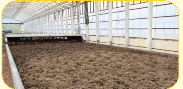
↑ 集められた牛ふんと野菜残さ（JAめむろフーズで出た枝豆など）は、水分量が多いため、攪拌しながら約２週間ほど乾燥させます。
