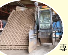
← 堆肥から出る水蒸気でわかりづらいたと思いますが、上の写真の専用攪拌機で山積みになった堆肥を攪拌して発酵を促します。
