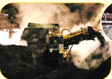
← 堆肥から出る水蒸気でわかりづらいたと思いますが、上の写真の専用攪拌機で山積みになった堆肥を攪拌して発酵を促します。
