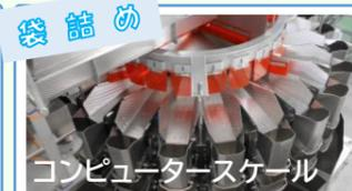
袋詰めの際は、コンピューターで自動的に量を計測。
