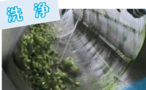
機械で茎の部分をカットし、花蕾部分はドラム洗浄機で洗浄します。
