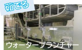
巨大な水槽で原料を一定の温度、時間で茹でる機械でブロッコリーを茹でます。機械を使って、ブロッコリーを水で冷やします
